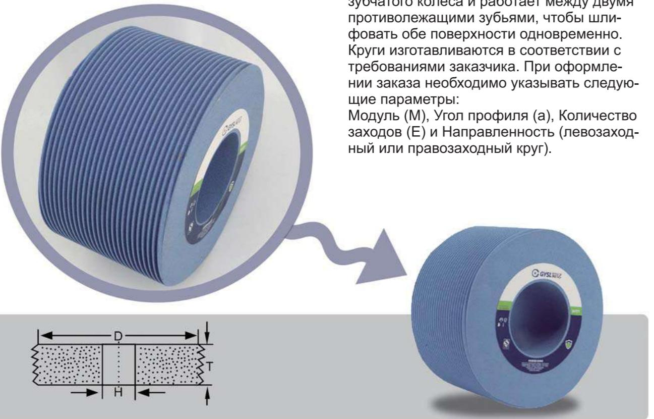
Круг в точности копирует форму зуба зубчатого колеса и работает между двумя противолежащими зубьями, чтобы шлифовать обе поверхности одновременно. Круги изготавливаются в соответствии с требованиями заказчика. При оформлении заказа необходимо указывать следующие параметры: Модуль (M), Угол профиля (α), Количество заходов (E) и Направленность (левозаходный или правозаходный круг).
